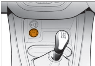
Рис. 2. Розетка для подключения дополнительного электрооборудования
