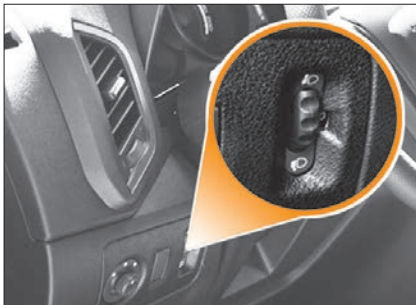
Рис. 3.15. Колесико переключателя электрокорректора угла наклона света фар
