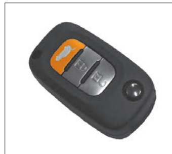
Рис. 1.5. Кнопка открывания двери задка пульта дистанционного управления
