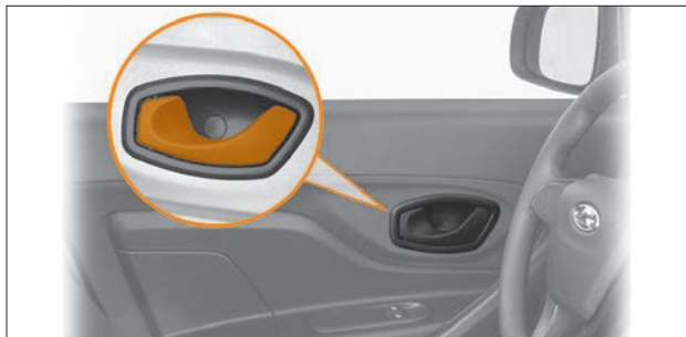
Рис. 1.14. Ручка для отпирания дверей из салона
