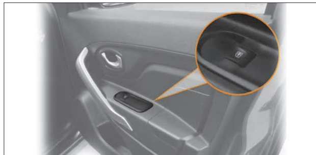
Рис. 1.21. Кнопка управления электрическим стеклоподъемником двери переднего пассажира
