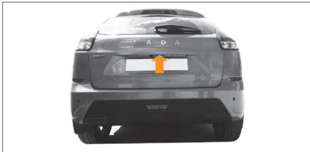
Рис. 1.9. Кнопка открывания двери задка
