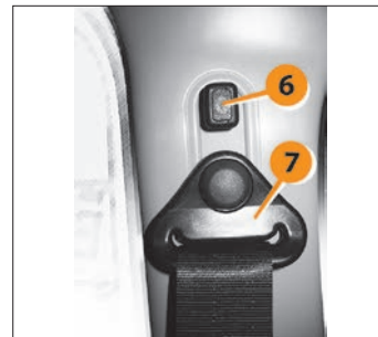
Рис. 2.11. Регулировка переднего ремня безопасности
