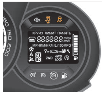
Рис. 4.7. Сигнализаторы «ESC» и «ESC OFF»
