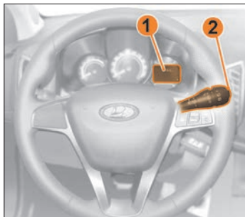
Рис. 3.6. Кнопки управления бортовым компьютером на переключателе стеклоочистителей
