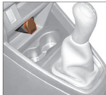
Рис. 7.5. Розетка для подключения дополнительного электрооборудования
