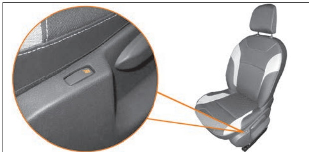
Рис. 2.4. Выключатель подогрева передних сидений (с фиксированными положениями)
