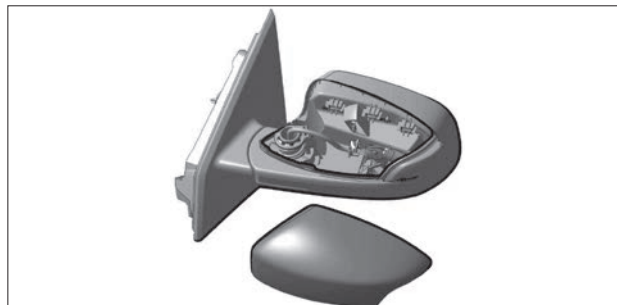
Рис. 8.19. Снятие накладки зеркала
