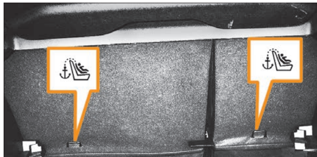
Рис. 2.18. Кронштейны для верхнего страховочного ремня ISOFIX
