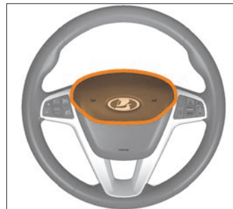
Рис. 3.10. Активация звукового сигнала
