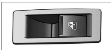
Рис. 12. Переключатель стеклоподъемника пассажирский (в варианном исполнении)
