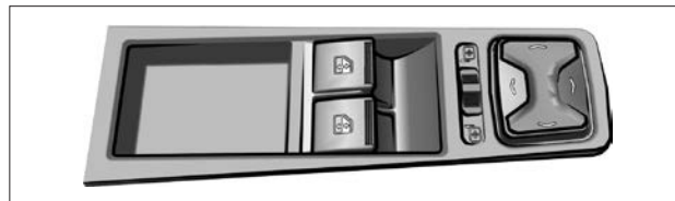
Рис. 10. Блок переключателей (в варианном исполнении)
