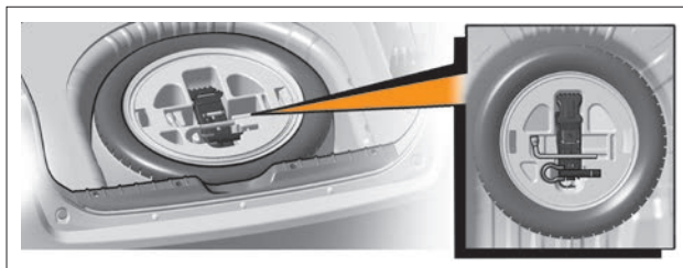
Рис. 4. Укладка запасного колеса
