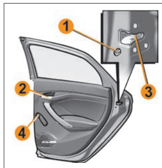
Рис. 7. Запирание задней двери
