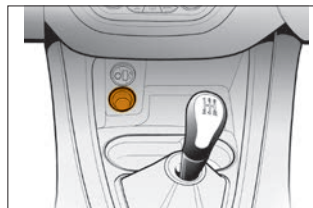
Рис. 1а. Розетка для подключения дополнительного электрооборудования
