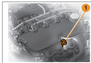
Рис. 4. Проверка уровня масла в картере двигателя
