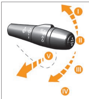
Рис. 16. Рычаг переключателя стеклоочистителей
