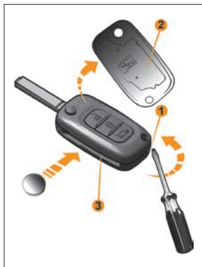
Рис. 10. Замена элемента питания пульта дистанционного управления
