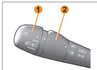
Рис. 15. Кольца управления на рычаге переключателя
