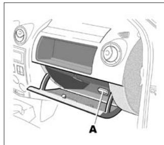
Заглушка **A** на задней стенке вещевого ящика закрывает розетку, предназначенную исключительно для работ, осуществляемых у дилера LADA.
