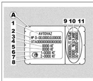
народным стандартам обозначают код завода-изготовителя; шесть следующих цифр – модель автомобиля; буква латинского алфавита (или цифра) – модельный год выпуска автомобиля; последние семь цифр – номер шасси, для легкового автомобиля соответствующий номеру кузова. В соответствии с Техническим регламентом «О безо-
