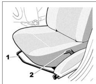
Поднимите ручку **1**, чтобы разблокировать сиденье. Установив сиденье в нужное положение, отпустите рычаг и проверьте надежность фиксации сиденья. Подушка сиденья опускается вниз под весом водителя. Для того, чтобы поднять подушку сиденья, необходимо приподняться с неё.
