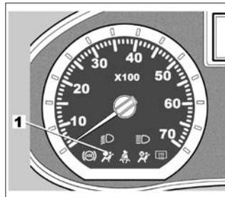
При включении зажигания на несколько секунд загорается сигнальная лампа **1**, расположенная на щитке приборов. Если при включении зажигания сигнальная лампа не загорается или загорается при работающем двигателе, это свидетельствует о неисправности в системе подушки
