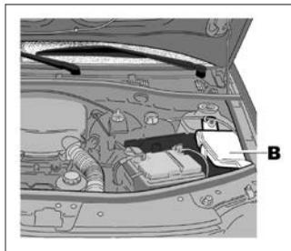
Некоторые системы защищены предохранителями, находящимися в моторном отсеке в блоке ***B***. Тем не менее, ввиду затрудненного доступа **рекомендуем Вам обращаться для замены этих предохранителей к дилеру LADA.**
