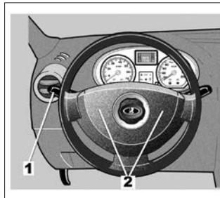
Нажмите до упора на торцевую кнопку рычага подрулевого переключателя **1**.
