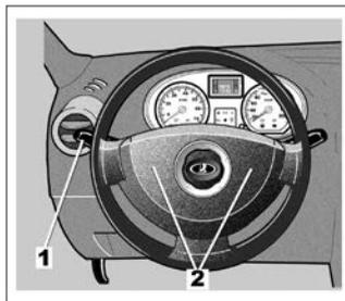
Для включения указателей поворотов передвиньте рычаг подрулевого переключателя **1** в плоскости рулевого колеса в направлении предполагаемого поворота. При движении по автостраде обычно недостаточно только поворотов рулевого колеса для автоматического возврата рычага подрулевого переключателя в нейтральное положение.
