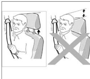
Вставьте стержни подголовника в отверстия направляющих втулок так, чтобы пазы на стержнях были обращены в сторону передней части автомобиля, и установите подголовник на нужную высоту.
