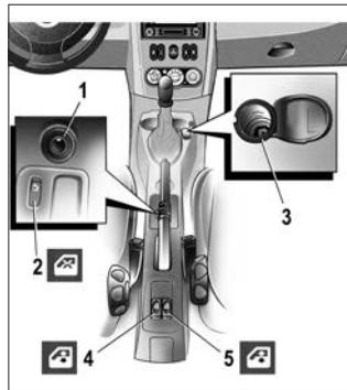
При включенном зажигании нажмите на прикуриватель **1** до упора. После нагрева спирали прикуриватель автоматически вернется в исходное положение (со щелчком). Извлеките прикуриватель. После прикуривания вставьте его в гнездо, не утапливая полностью.
