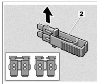
Извлеките предохранитель с помощью зажима **2**, расположенного на тыльной стороне крышки **A**. Чтобы извлечь предохранитель из пинцета, сдвиньте его в сторону (как показано на рисунке). Свободные гнезда для предохранителей использовать не рекомендуется.
