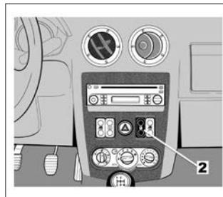
Заблокируйте или разблокируйте замки дверей, нажав на выключатель **2**. Эта кнопка позволяет одновременно запирать и отпирать замки четырех боковых дверей и задней двери. Замок передней двери нельзя запереть, если дверь открыта.
