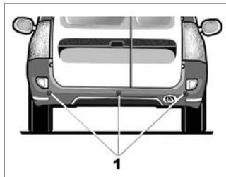
**В варианном исполнении** автомобиля оснащаются системой безопасной парковки парктроник (от англ. parktronic). Система поможет избежать досадных мелких аварий и следующих за ними материальных затрат. Датчики парковки **1** помогут вам обнаружить опасное
