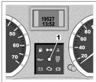
При включении зажигания сигнальная лампа **1** горит, не мигая, в течение приблизительно трех секунд, затем гаснет. Автомобиль распознал код. Вы можете запустить двигатель.
