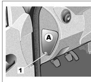
При неисправности одного из электроприборов, прежде всего, проверьте соответствующие предохранители. Отсоедините крышку **A**, используя выемку **1**.
