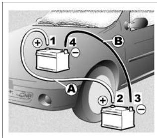
Запустите двигатель автомобиля, от которого выполняется заряд, и оставьте его работать при средней частоте вращения коленчатого вала двигателя.
