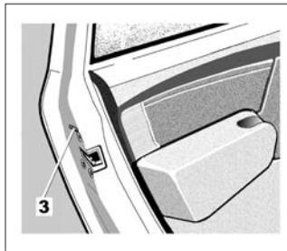
Чтобы сделать невозможным открытие задних боковых дверей автомобиля изнутри, переместите рычажок **3** на каждой двери, закройте двери и изнутри проверьте надежность их блокировки.
