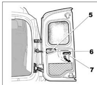
Сначала закройте меньшую из дверей, затем – большую. При этом фиксаторы **6** займут исходное положение.
