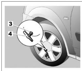
Снимите его с помощью ключа для снятия декоративного колпака, вставив ключ **4** в выемку **3**, и выверните болт. Для установки на место ориентируйте выемку **3** до совпадения с крепежным отверстием колпака на колесном диске, установите болт и заверните его при помощи ключа **4**.
