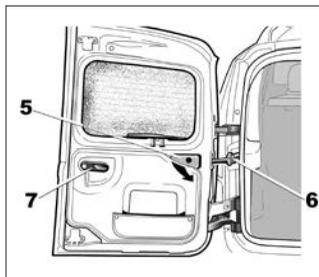
Чтобы полностью открыть дверь, разблокируйте фиксатор, потянув за ручку предохранителя **5**, затем откройте дверь так, чтобы можно было освободить фиксатор **6**. Аналогично откройте другую дверь.
