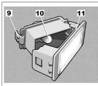
Нажмите на фиксатор **9**, чтобы отсоединить рассеиватель **11** и получить доступ к лампе **10**.
