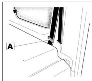
Когда ремень безопасности в третьем ряду сидений не используется, он обязательно должен быть прикреплен к крючку **A**, чтобы не повредить ремень или полку багажного отделения (если она имеется на Вашем автомобиле).
