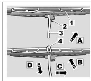
При выключенном зажигании поднимите рычаг стеклоочистителя **3**.
