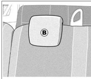
**Рабочее положение подголовника В.** Поднимите подголовник до положения блокировки, чтобы использовать его в верхнем положении. Одновременно нажмите на фиксаторы 3 и 4 и полностью опустите подголовник.
