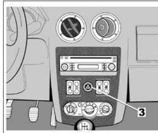
Нажмите на выключатель **3**. Одновременно начинают мигать все четыре указателя поворота и боковые повторители указателей поворотов. Аварийная световая сигнализация должна быть включена:
