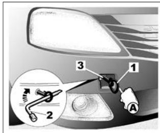
Откройте крышку **A**, вставив отвертку с плоским лезвием под крышку.
