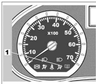
Снова включите зажигание и **обязательно** убедитесь, что сигнальная лампа **1**
