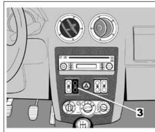
При работающем двигателе нажмите на клавишу **3** (на щитке приборов загорится сигнальная лампа). Эта функция обеспечивает электрообогрев/обдув заднего стекла и, в зависимости от комплектации автомобиля, зеркал заднего вида.
