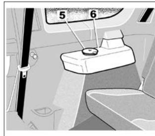
Может устанавливаться в одно из отделений **2**, **3**, **4** или **6**. Чтобы открыть пепельницу, поднимите крышку **5**. Чтобы очистить пепельницу, выньте ее и вытряхните. Если на Вашем автомобиле не установлены прикуриватель и пепельница, Вы можете приобрести их у дилера компании-производителя.
