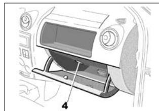
Отсоедините фонарь **4** с помощью отвертки с плоским лезвием, надавив на фиксатор и потянув фонарь внутрь ящика. Отсоедините плафон.
