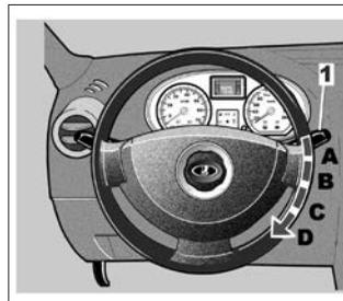
При включенном зажигании поворачивайте рычаг подрулевого переключателя **1** параллельно рулевому колесу:
