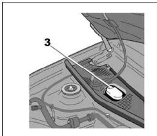
**Заправка:** откройте пробку **3**, залейте жидкость до видимого уровня и закройте пробку. Этот бачок обеспечивает жидкостью омыватели ветрового и заднего стекол.
