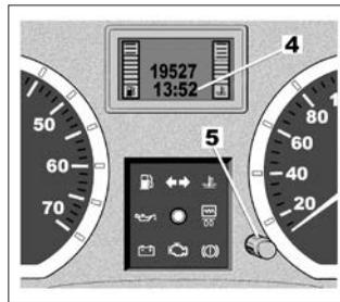
**При включенном зажигании** выберите на дисплее **4** показания счетчика суммарного пробега и часов. Для перехода в режим установки времени удерживайте кнопку **5** в течение 5 с. Есть две возможности установить точное время:
