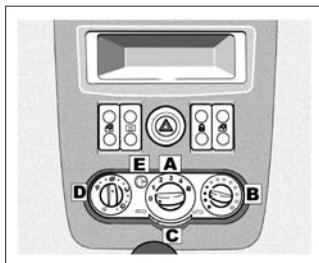
Кнопка **E** служит для включения или выключения кондиционера.
