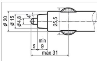
чения только 12-вольтовых электрических приборов, рассчитанных на напряжение 12В и максимальную силу тока 10А. Перегрузка розетки может привести к выходу из строя электропроводки автомобиля и короткому замыканию.
