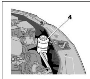
**Уровень:** правильный уровень **в холодном состоянии** на горизонтальной площадке при остановленном двигателе должен быть виден между метками «**MIN**» и «**MAX**» на бачках **4** или **5**. Для выполнения технического обслуживания усилителя рулевого управления обращайтесь к дилеру
