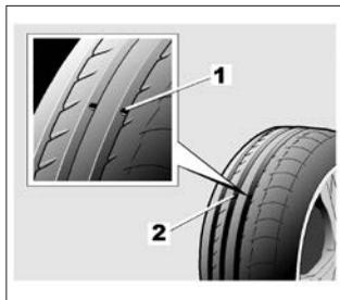
Шины должны быть в исправном состоянии, а протектор должен иметь достаточную глубину рисунка; шины, рекомендованные техническими отделами компании-производителя, имеют специальные выступы-индикаторы износа **1**, которые **отформованы на беговой дорожке колеса**.
