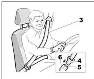
**Медленно, без рывков** вытяните ремень и вставьте пряжку ремня **4** в замок **6** (проверьте надежность фиксации ремня в замке, потянув за пряжку **4**). Если при вытягивании ремня срабатывает механизм его блокировки, отпустите ремень назад на значительное рас-
