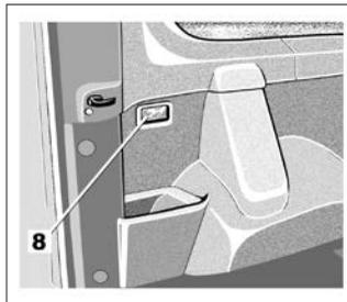
Отсоедините фонарь **8** с помощью отвертки с плоским лезвием, надавив на фиксатор и потянув фонарь на себя.
