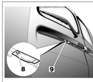
Отверните винт **8** с помощью инструмента типа плоской отвертки. Снимите крышку фонаря для доступа к лампе **9**.
