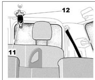
Медленно вытяните ремень **11** из гнезда **12**. В целях обеспечения безопасности проденьте ремень безопасности в его направляющую **13**. Вставьте язычок в замок черного цвета **14** до щелчка. Затем защелкните скользящую пряжку **15** в замке красного цвета **16**.
