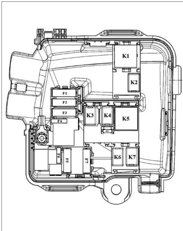
**Рис. 2. Блок предохранителей и реле моторного отсека (ДВС 11189)**
