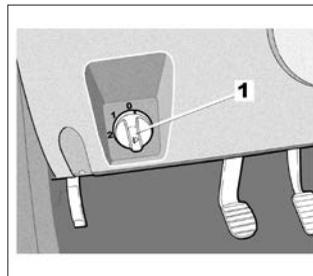
Ручка **1** служит для регулировки света фар в вертикальной плоскости в зависимости от загрузки автомобиля.
