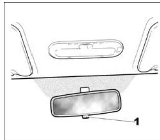
Положение зеркала регулируется. Во время движения в темное время суток во избежание ослепления светом фар идущего сзади автомобиля нажмите на рычажок **1**, расположенный в нижней части корпуса зеркала.
