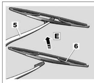
При выключенном зажигании поднимите рычаг стеклоочистителя **5**.
