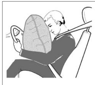
Этими подушками безопасности могут быть оборудованы места водителя и переднего пассажира. Надписи «Airbag» на рулевом колесе и на приборной панели, а также соответствующая наклейка на нижней части ветрового стекла или на солнцезащитном козырьке свидетельствуют о том, что данное
