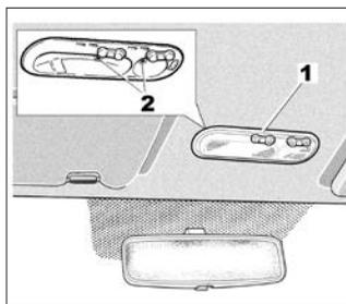
С помощью отвертки с плоским лезвием отсоедините рассеиватель **1**. Извлеките перегоревшую лампу.
