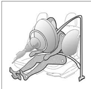
Если зажигание включено, при сильном фронтальном ударе, в зависимости от силы удара, система может задействовать один поршень, который мгновенно отводит замок ремня безопасности назад.
