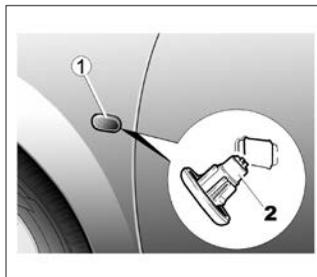
С помощью инструмента типа плоской отвертки отсоедините боковой повторитель указателей поворота **1**. Поверните патрон **2** на четверть оборота, чтобы извлечь лампу.
