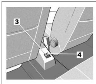
При включенном зажигании нажмите на переключатель **3** или **4**, чтобы опустить стекло, или приподнимите переключатель **3** или **4**, чтобы поднять стекло на нужную высоту. Нажмите на переключатель **5**, чтобы заблокировать задние стеклоподъемники.
