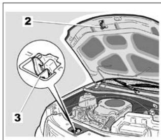
Для разблокировки замка слегка приподнимите капот и освободите крюк **2**, надавив влево на пластинку **3**.
