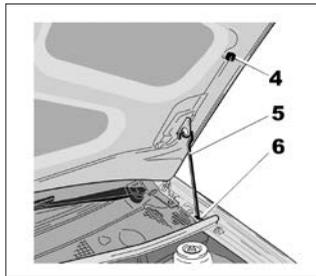
Поднимите крышку капота, освободите упор **5** из фиксатора **4** и, что очень важно для обеспечения Вашей безопасности, **обязательно** вставьте его в гнездо **6** левого крыла.
