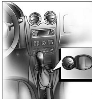
Розетка для подключения дополнительного электрооборудования используется для подключения только 12-вольтовых электрических приборов мощностью не более 120 Вт.
