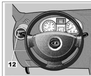
Для изменения направления потока воздуха поворачивайте вентиляционную решетку **12**.
