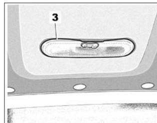
С помощью отвертки с плоским лезвием отсоедините рассеиватель **3**. Извлеките лампу.
