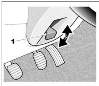
Поднимите рычаг **1** и установите рулевое колесо в требуемое положение. Опустите рычаг для блокировки перемещения рулевой колонки. Проверьте надежность фиксации рулевого колеса.
