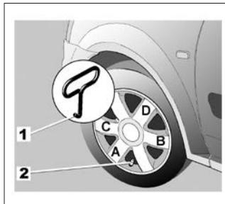
Снимите его с помощью ключа для снятия декоративного колпака **1**, вставив ключ в выемку клапана **2**. При установке правильно расположите его относительно вентиля **2**. Вставьте фиксаторы, начиная со стороны клапана **A**, затем **B** и **C** и заканчивая стороной **D**, противоположной клапану.
