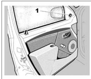
Регулировка зеркала производится с помощью рычага **1**.
