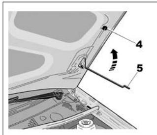
Прежде чем закрыть капот, убедитесь, что Вы ничего не забыли в моторном отсеке. Чтобы закрыть капот, возьмитесь за середину передней кромки капота, приподнимите его, установите упор **5** в фиксатор **4** и опустите его примерно до высоты 20 см от закрытого положения, затем отпустите. Капот
