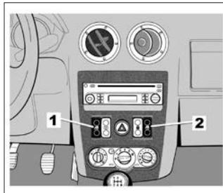
При включенном зажигании нажмите на нижнюю часть переключателя **1** или **2**, чтобы опустить стекло, или на верхнюю часть переключателя **1** или **2**, чтобы поднять стекло на нужную высоту.
