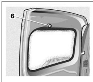
Отверните винт **6** с помощью ключа типа «Торкс» № T30 и извлеките фонарь **7** из его гнезда.
