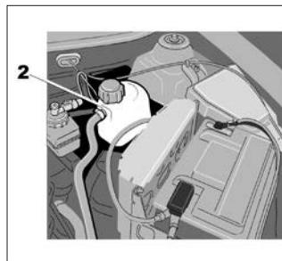
На остановленном на горизонтальной площадке автомобиле с выключенным двигателем уровень **на холодном двигателе** должен находиться между метками «MIN» и «MAX» расширительного бачка **2**.
