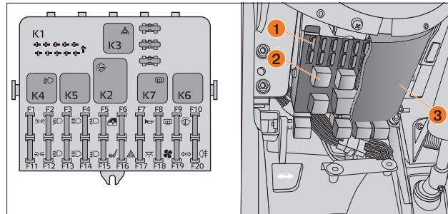
Рис. 84. Монтажный блок – схема установки
