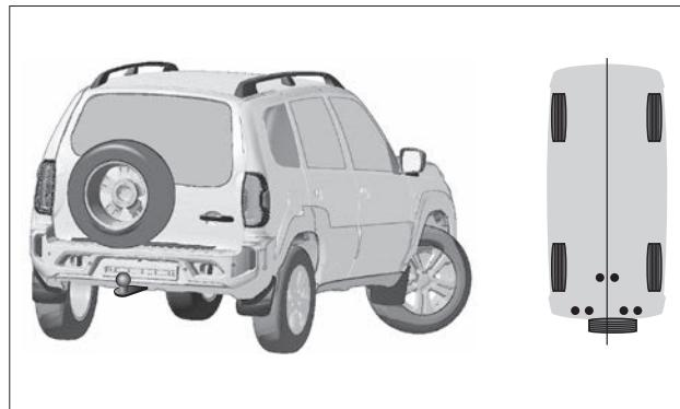
Рис. 34. ТСУ и точки его крепления (в вариантом исполнении)
