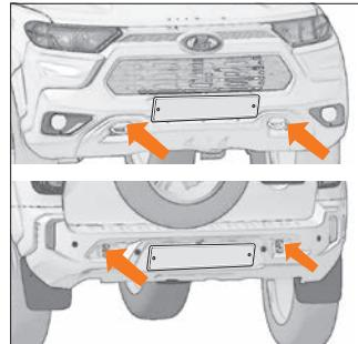
**Рис. 67. Буксирование проушины**
