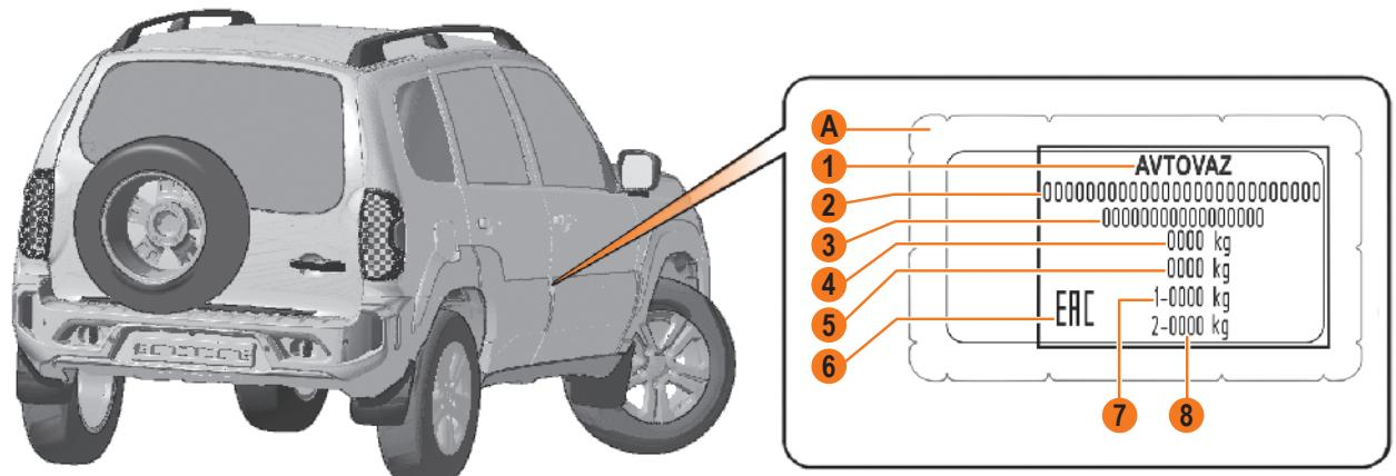
Рис. 91. Табличка изготовителя (в вариантом исполнении)
