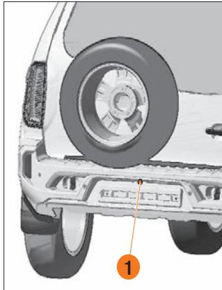
Рис. 70. Камера заднего вида
