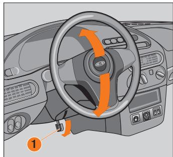
Рис. 6. Рукоятка регулировки положения рулевой колонки
