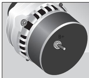
Рис. 80. Клемма «B+» генератора
