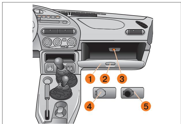
Рис. 33. Охлаждаемый вещевой ящик (в вариантом исполнении)
