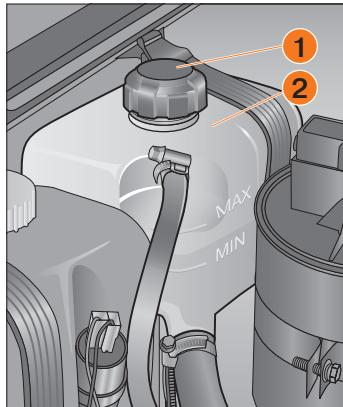
Рис. 75. Проверка уровня охлаждающей жидкости в расширительном бачке
