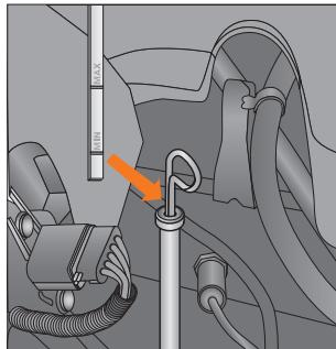
Рис. 74. Проверка уровня масла в картере двигателя
