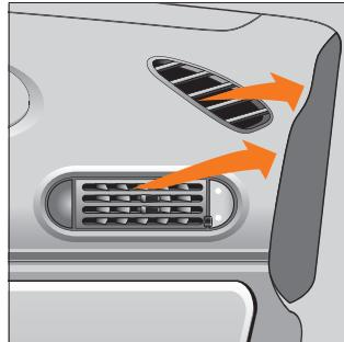
Рис. 57. Дефлекторы подачи воздуха на стекла передних дверей
