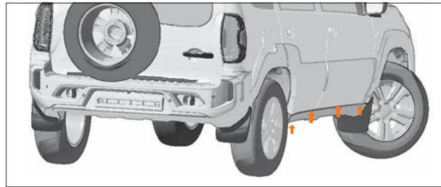
Рис. 89. Дренажные отверстия дверей и порогов
