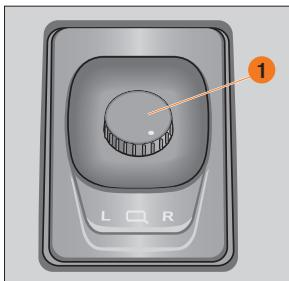
Рис. 28. Блок управления наружными зеркалами
