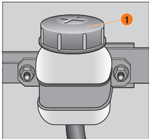
**Рис. 77. Бачок гидропривода выключения сцепления**
