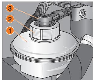
Рис. 76. Проверка уровня тормозной жидкости
