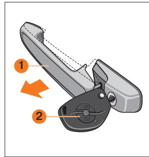
Рис. 7. Открывание дверей
