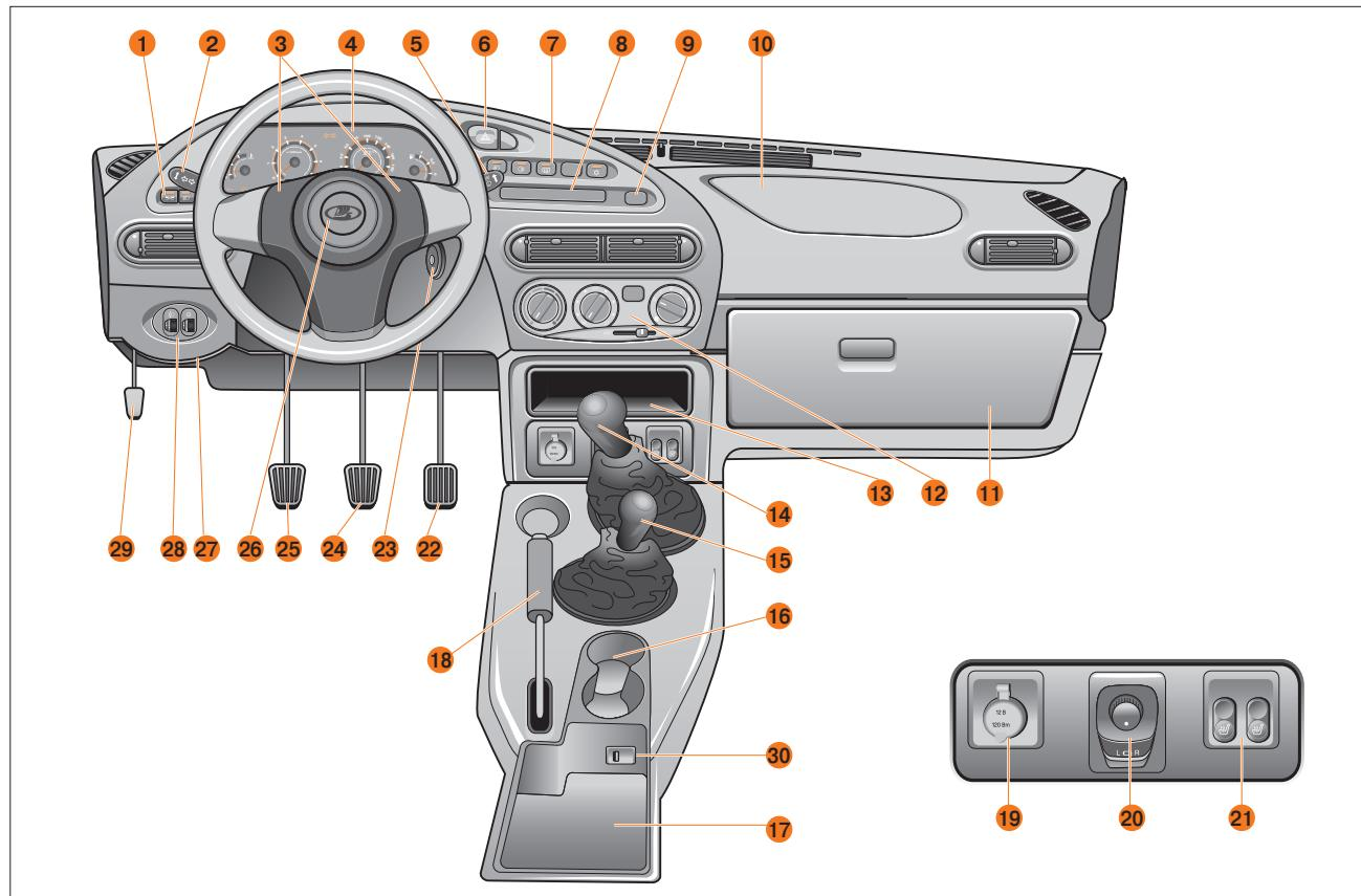
Рис. 39. Панель приборов
