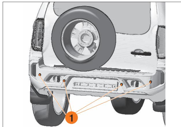
Рис. 69. Датчики парковки (в вариантом исполнении)
