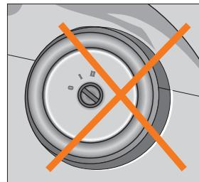
Рис. 65. Недопустимое положение выключателя зажигания
