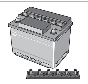
Рис. 79. Проверка уровня электролита в аккумуляторной батарее
