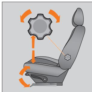
Рис. 14. Рукоятки регулировки сиденья (в вариантом исполнении)
