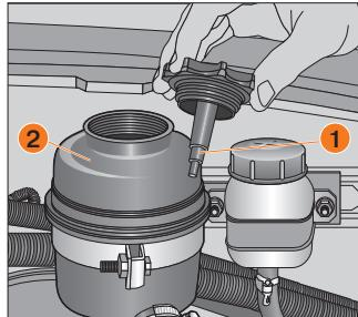
Рис. 78. Бачок насоса гидроусилителя
