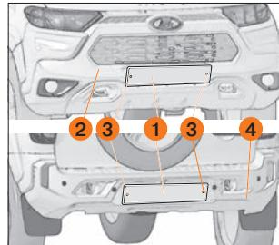
Рис. 64. Крепление номерных знаков
