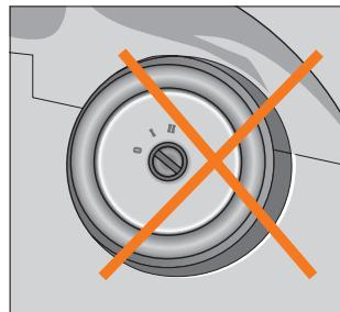
Рис. 68. Недопустимое положение выключателя зажигания
