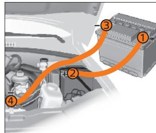
**Рис. 66. Схема подключения пусковых проводов к вспомогательной батарее**
