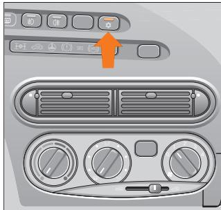
Рис. 63. Предохранение стёкол от запотевания и замерзания
