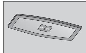
Рис. 31. Задний плафон освещения салона (в вариантом исполнении)
