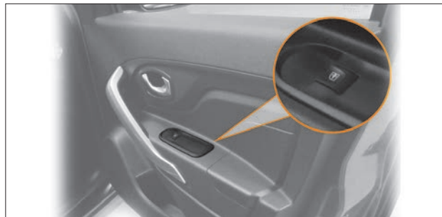
Рис. 1.21. Кнопка управления электрическим стеклоподъемником двери переднего пассажира
