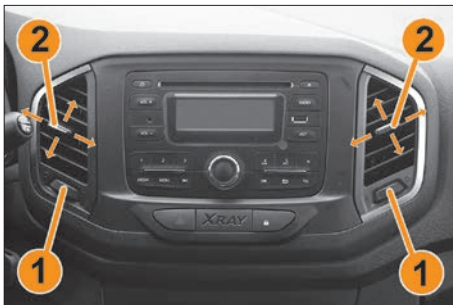
Рис. 6.2. Регулировка воздушных потоков через вентиляционные сопла
