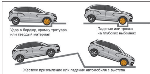
Рис. 2.14. Примеры ситуаций срабатывания подушек безопасности
