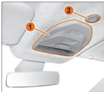
Рис. 7.2а. Общий вид блока освещения салона
