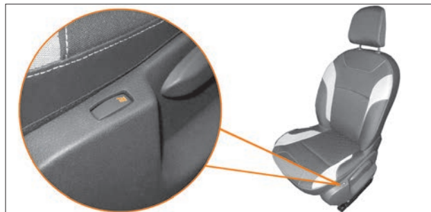
Рис. 2.4.1. Выключатель подогрева передних сидений (с фиксированными положениями)
