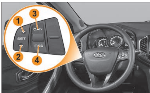
Рис. 5.1. Блок управления системами «Круиз-контроль» и «Ограничитель скорости» на рулевом колесе
