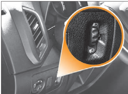
Рис. 3.15. Колесико переключателя электрокорректора угла наклона света фар
