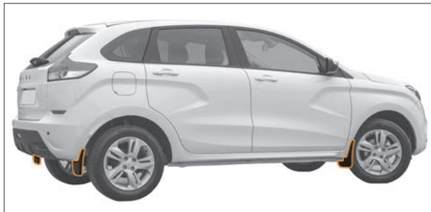
Рис. 8.30. Щитки переднего и заднего крыла
