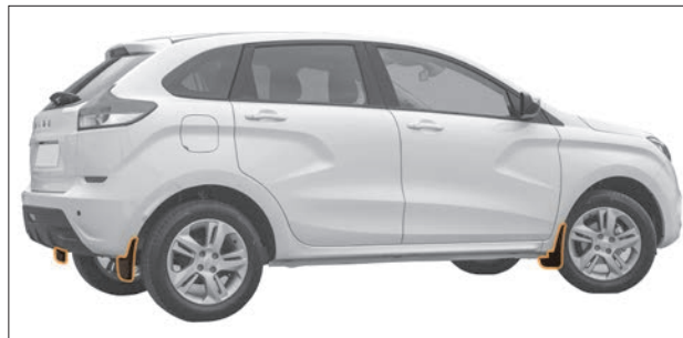
Рис. 8.30. Щитки переднего и заднего крыла
