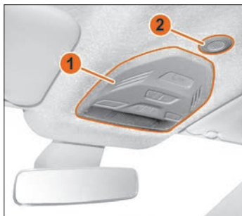
Рис. 7.2а. Общий вид блока освещения салона
